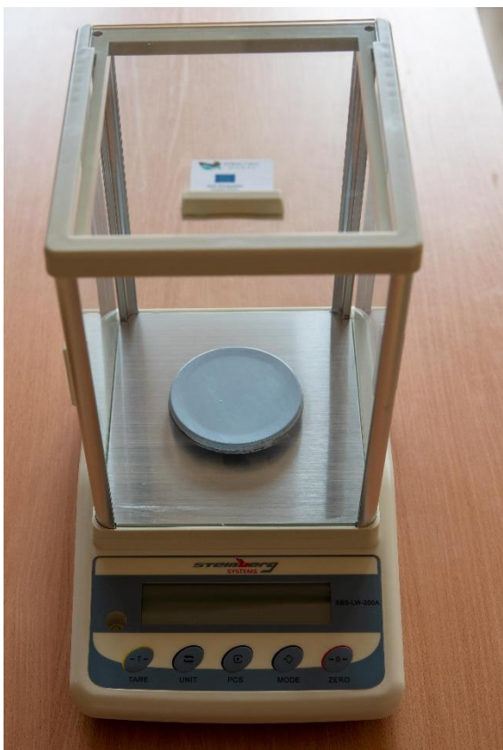
Waga laboratoryjna o zakresie ważenia 0,005 - 200 g, ze szklaną osłoną.
