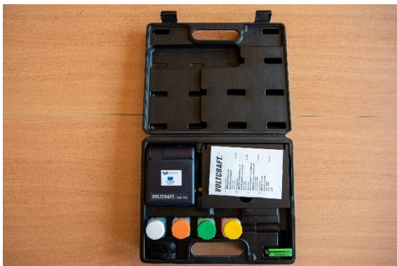
Urządzenie pomiarowe do oznaczania: pH, redox, przewodności, temperatury.
