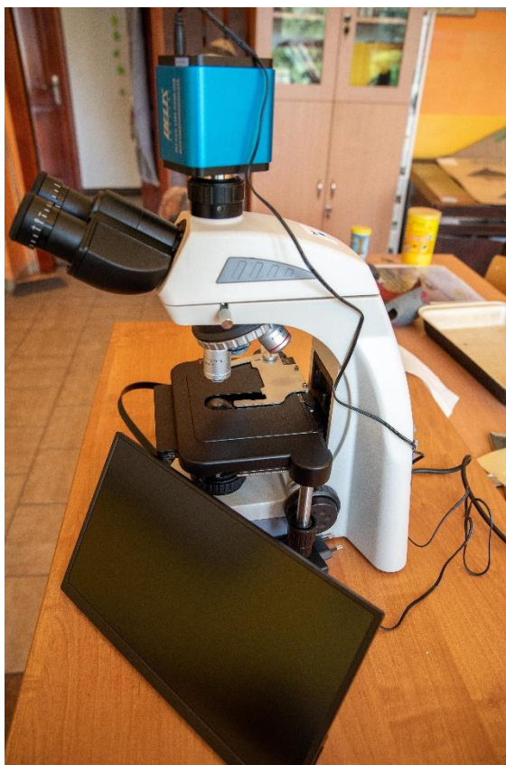
Mikroskop z kamerą i wyświetlaczem HDMI.
