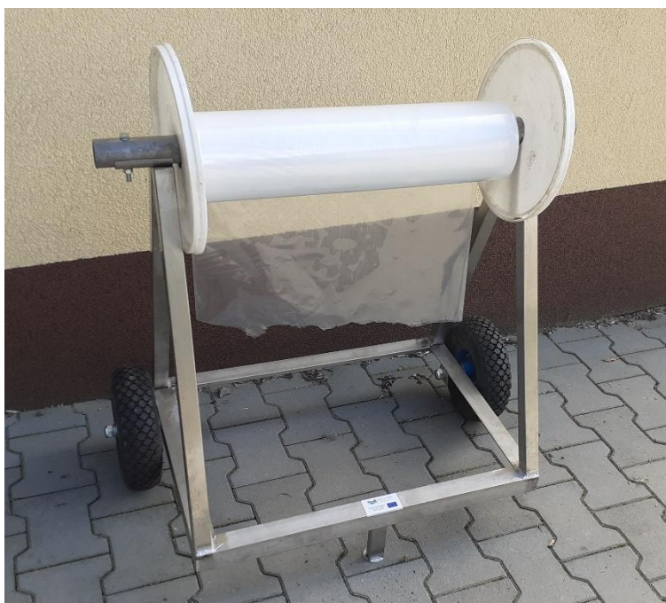
Stelaż ze stali nierdzewnej do rękawa foliowego do przygotowania worków z tlenem do transportu ryb.
