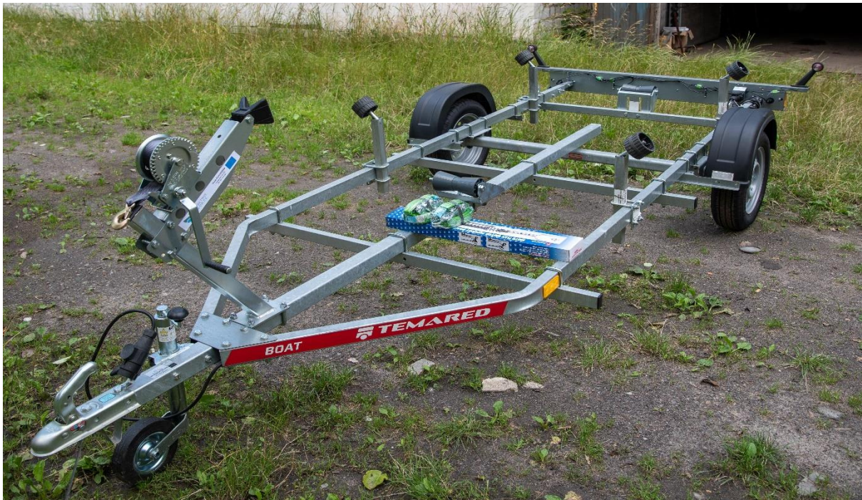
Przyczepka podłodziowa, lekka o długości 4-5 m, z wyciągarką, z systemem rolek. Pasy transportowe i podpora silnika.
