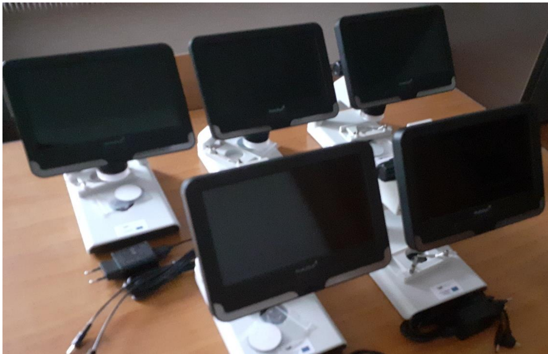
Binokulary cyfrowe jednotorowe z ekranem 7 cali i kamerą 12 Mpix.
