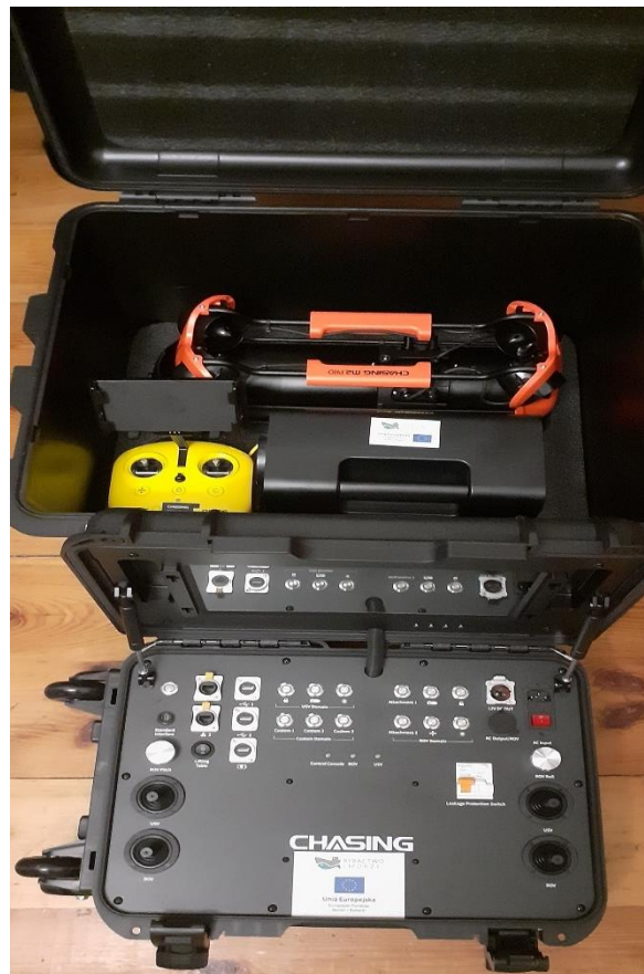
Dron podwodny z kamerą 4K, stacją sterującą, próbnikiem i okablowaniem.
