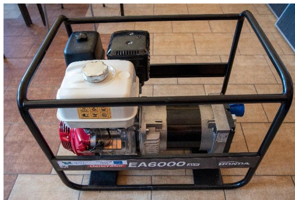
Agregat prądotwórczy 1-fazowy.
