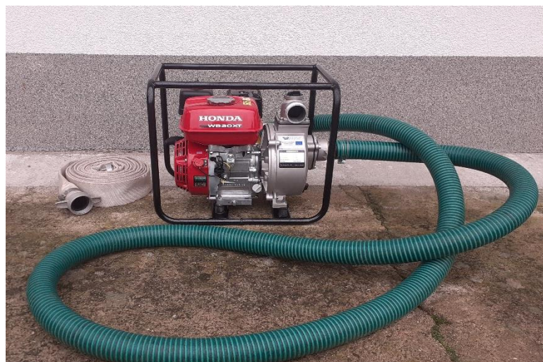
Motopompa do wody czystej o wydajności 500 l/h.
