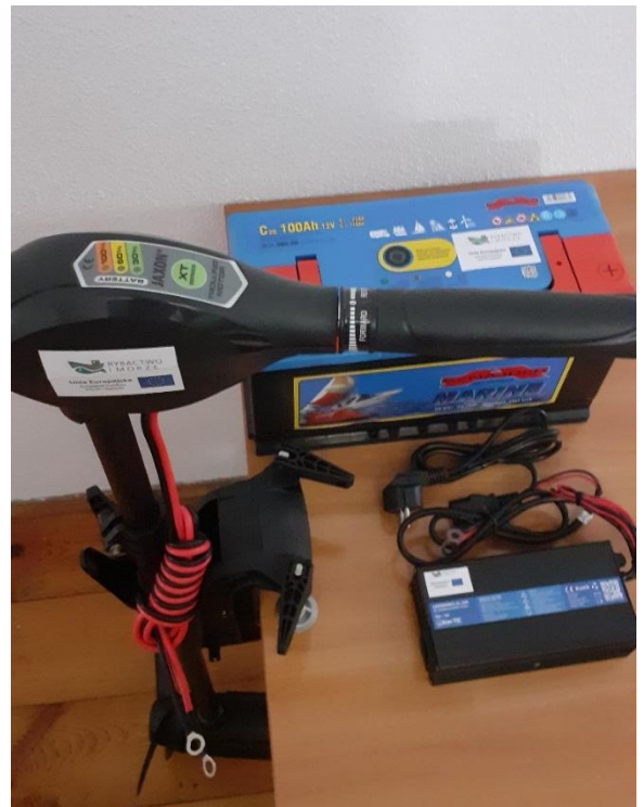
Silnik zaburtowy elektryczny z baterią i dedykowaną ładowarką.
